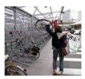
Ne cherchez pas à porter la bécane à pédales à bout de bras, c'est idiot. Il faut ramener la rampe jusqu'à soi, et la baisser pour y caler le vélo. Ne cherchez pas à porter la bécane à pédales à bout de bras, c'est idiot. Il faut ramener la rampe jusqu'à soi, et la baisser pour y caler le vélo.
