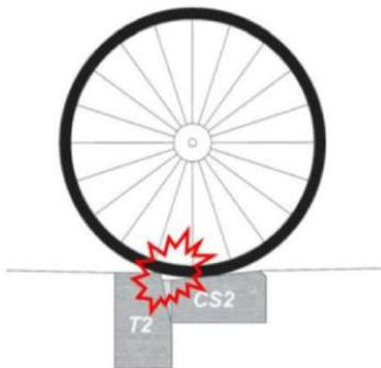
La pente du caniveau CS2 couplée au ressaut de 2 cm de la bordure T2 entraîne des chocs légers lors du franchissement de la bordure.
